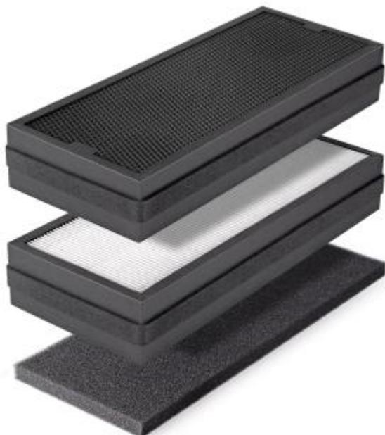
**Фильтр первичной очистки класса G4.** Установлен во всех бризерах. Задерживает пух, шерсть, крупные частицы пыли, пыльцы и другие загрязнители. Рекомендуется 1 раз в месяц пылесосить или промывать водой без использования бытовой химии. Частота замены – 1 раз в год в зависимости от условий эксплуатации.
