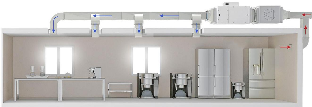
Tion Eco монтируется в канал приточной вентиляции для очистки приточного воздуха. Варианты установки: за подшивным потолком в помещении, в отдельной венткамере, на улице.
